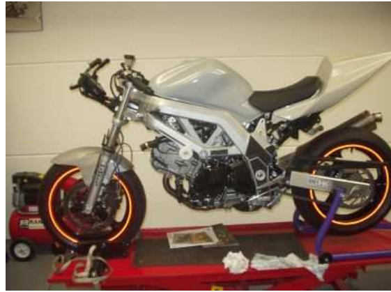
Opbouwen van de racemotor. Voorzien van nieuw bodywork, tank en eigen gemaakte crashdoppen.
