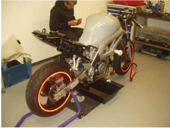
Opbouwen van de racemotor. Voorzien van nieuw bodywork, tank en eigen gemaakte crashdoppen.
